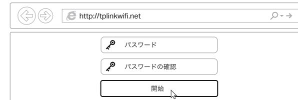
3. クイックセットアップが開始するので、表示に従って初期設定を行います。動作モード ルーターを選択して手順に従ってインターネット接続設定を行います。
